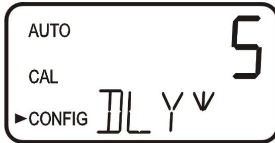
显示屏上将显示您所选的秒数。您可以通过▲和▼键选择所要的延迟关闭的时间，一旦您选定了延迟时间，按←键接受。设置完报警器 1 后，屏幕将提示您设置报警器 2。
