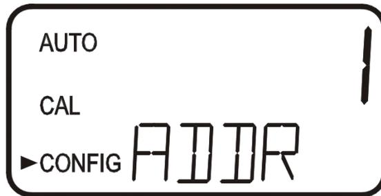
使用 MODBUS 协议，请选择 ASCII 或 RTU。详细说明请参考 MODBUS 协议手册（订货号：19777）。本手册可由[www.hfscientific.com](http://www.hfscientific.com)免费下载。
